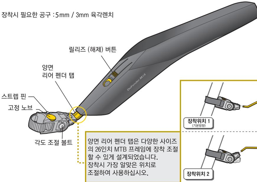
양면 리어 펜더 탭은 다양한 사이즈의 26인치 MTB 프레임에 장착 조절할 수 있게 설계되었습니다. 장착시 가장 알맞은 위치로 조절하여 사용하십시오.
